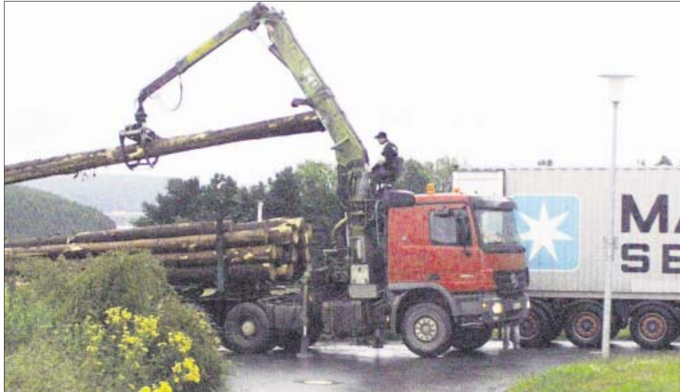
Auf befestigten Plätzen wird das Holz direkt vom Langholz-Lkw in Seecontainer umgeladen.
